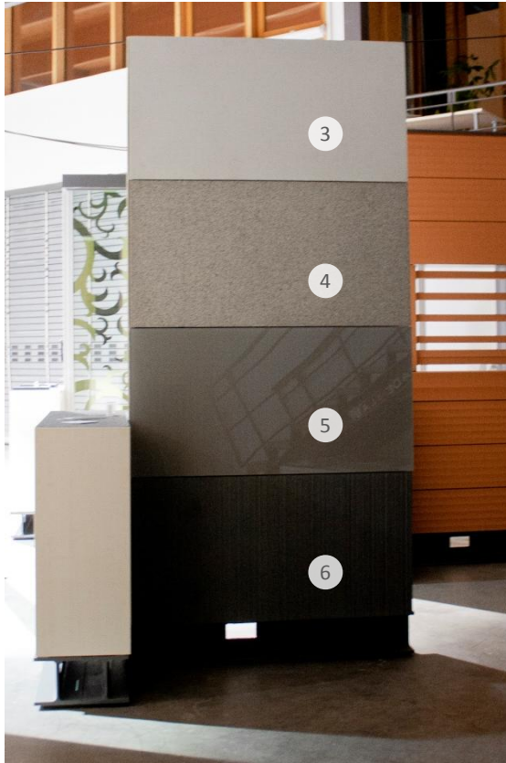
Verschiedene Oberflächen durch unterschiedliche Zuschläge und Veredelung Various surfaces with different aggregates and finishing
